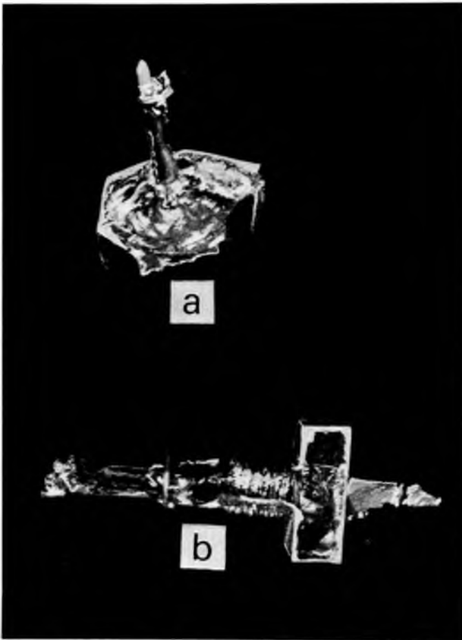
22-7. ábra. Elektrodinamikus nyomásos öntés formatöltési fázisai
