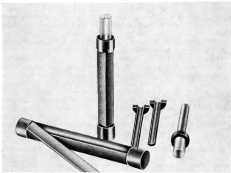
21-3. ábra. Szétszedhető, grafit—kvarc kombinációval készített szedőedények
