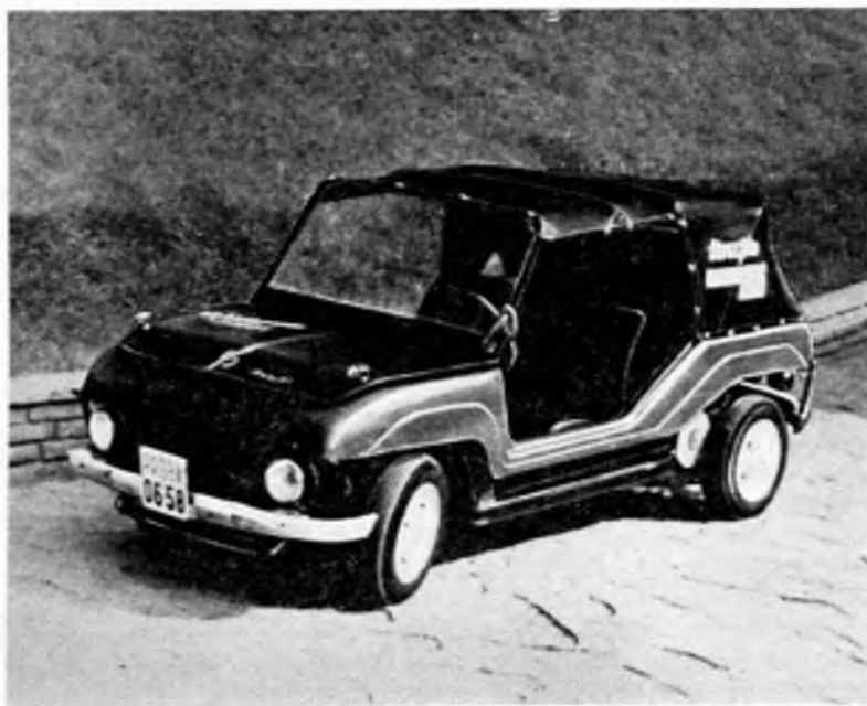
18-12. ábra. „Tiny 70” elnevezésű, tirisztoros szabályozású, közúti, villamos kisjármű
