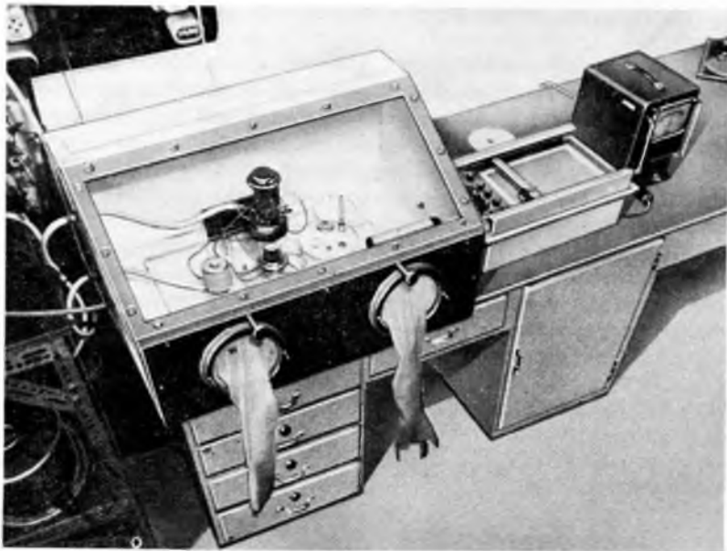
18-2. ábra. Glimm-plazmareaktor melting back diódák átmenetképzéséhez
